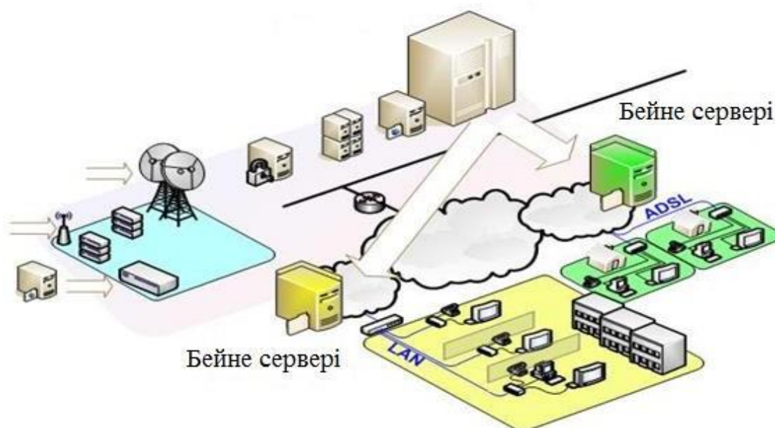
1.12 - сурет – Контентті үлестіру жүйесі жұмысы сұлбасы
